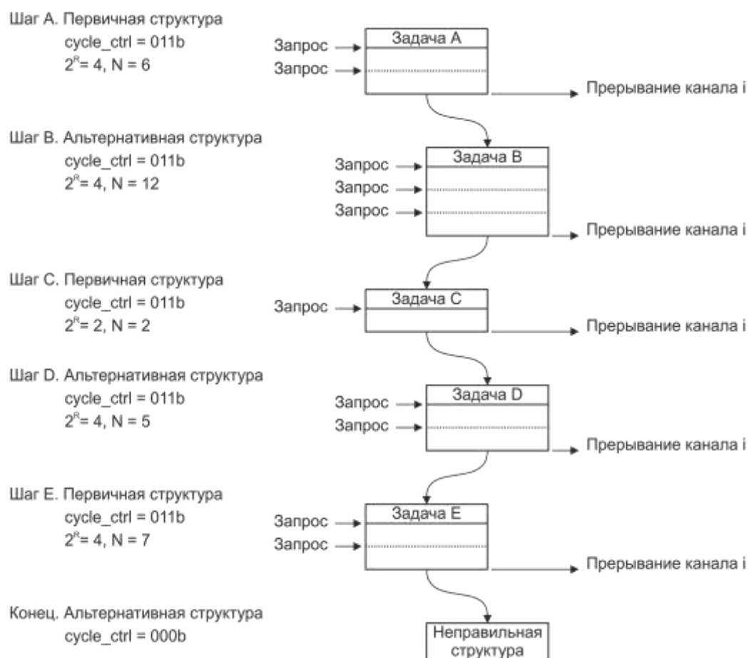
Рисунок 8.3 – Пример функционирования контроллера в режиме «пинг-понг»
