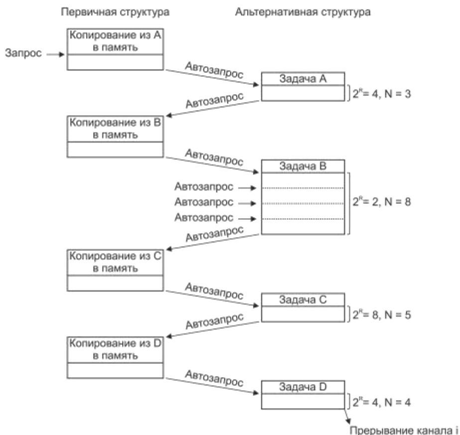
Рисунок 8.4 – Пример функционирования контроллера в режиме «разборка-сборка»
