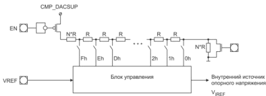
Рисунок 22.3 – Структурная схема модуля ЦАП
