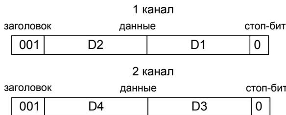
Сформированные посылки в последовательном коде (старшими разрядами вперед) поступают в шифраторы первого и второго каналов, где производится их преобразование в код «Манчестер-II».
