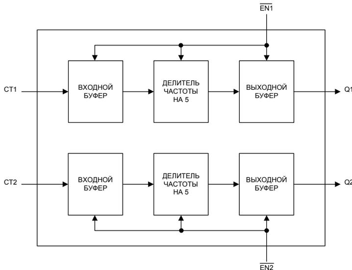
Микросхема содержит два канала деления:
