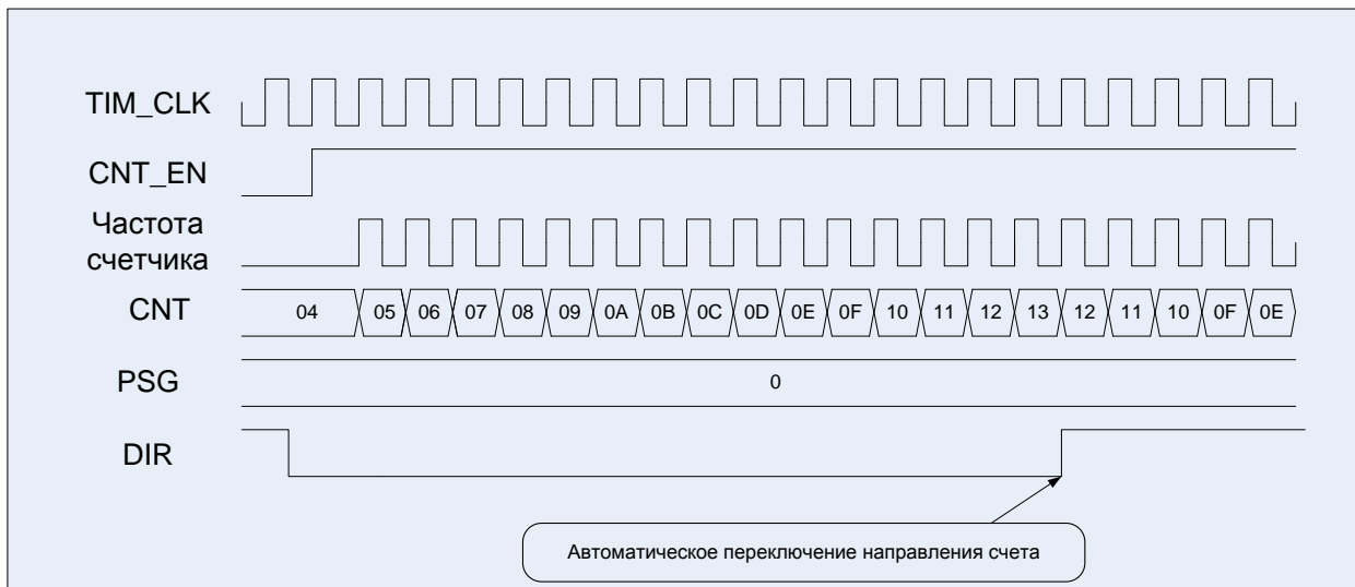
Рисунок 43. Диаграммы работы таймера, счет вверх/вниз, сначала вверх
