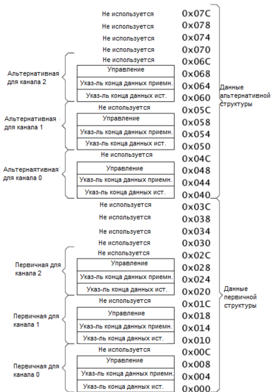
Рисунок 110. Карта памяти для трех каналов ПДП, включая альтернативную структуру управляющих данных
