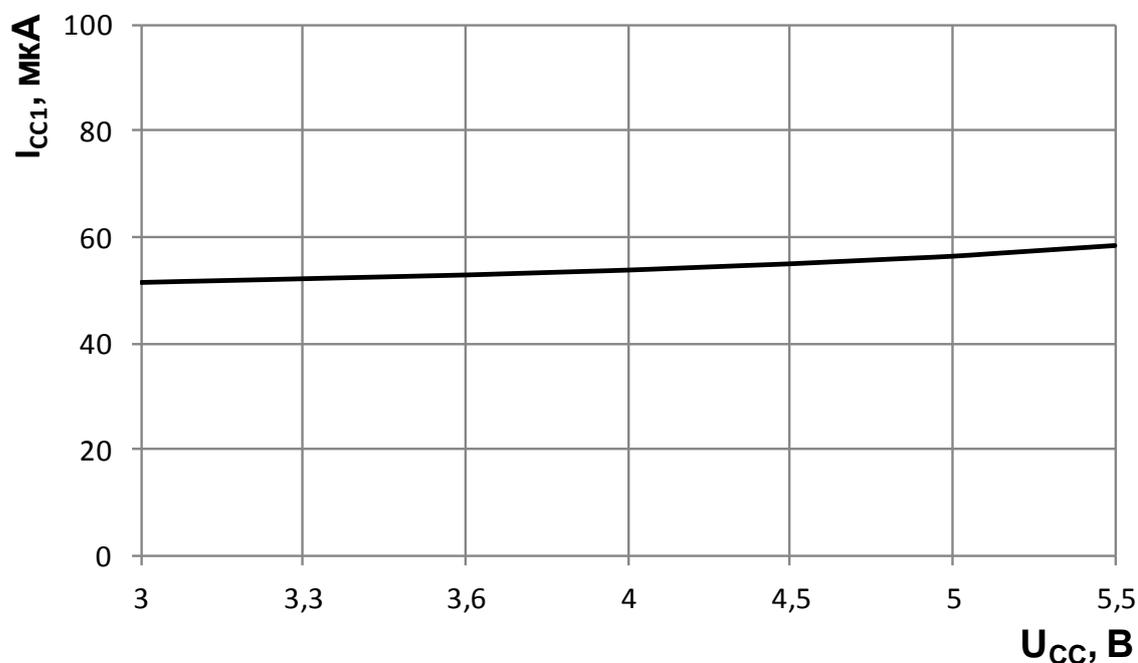
Рисунок 7 – Зависимость статического тока потребления  $I_{CC1}$  от напряжения питания цифровых блоков при  $T_A = 25 \text{ }^\circ\text{C}$ ,  $U_{EE+} = 16,5 \text{ В}$ ,  $U_{EE-} = -16,5 \text{ В}$ ,  $U_{IH} = U_{CC}$ ,  $U_{IL} = 0 \text{ В}$
