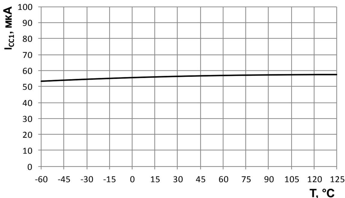
Рисунок 6 – Зависимость статического тока потребления  $I_{CC1}$  от температуры при  $U_{CC} = 5,5 \text{ В}$ ,  $U_{EE+} = 16,5 \text{ В}$ ,  $U_{EE-} = -16,5 \text{ В}$ ,  $U_{IH} = 5,1 \text{ В}$ ,  $U_{IL} = 0,4 \text{ В}$
