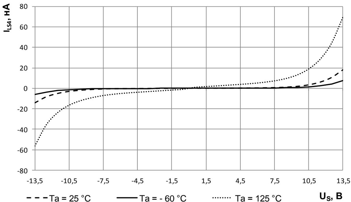
Рисунок 15 – Зависимость тока утечки входа/выхода ключа, не выбранного по адресу, от коммутируемого напряжения при  $U_{CC} = 5,5$  В,  $U_{EE+} = 16,5$  В,  $U_{EE-} = -16,5$  В,  $U_{OUT} = 0$  В,  $U_{EN1} = U_{EN2} = 5,5$  В
