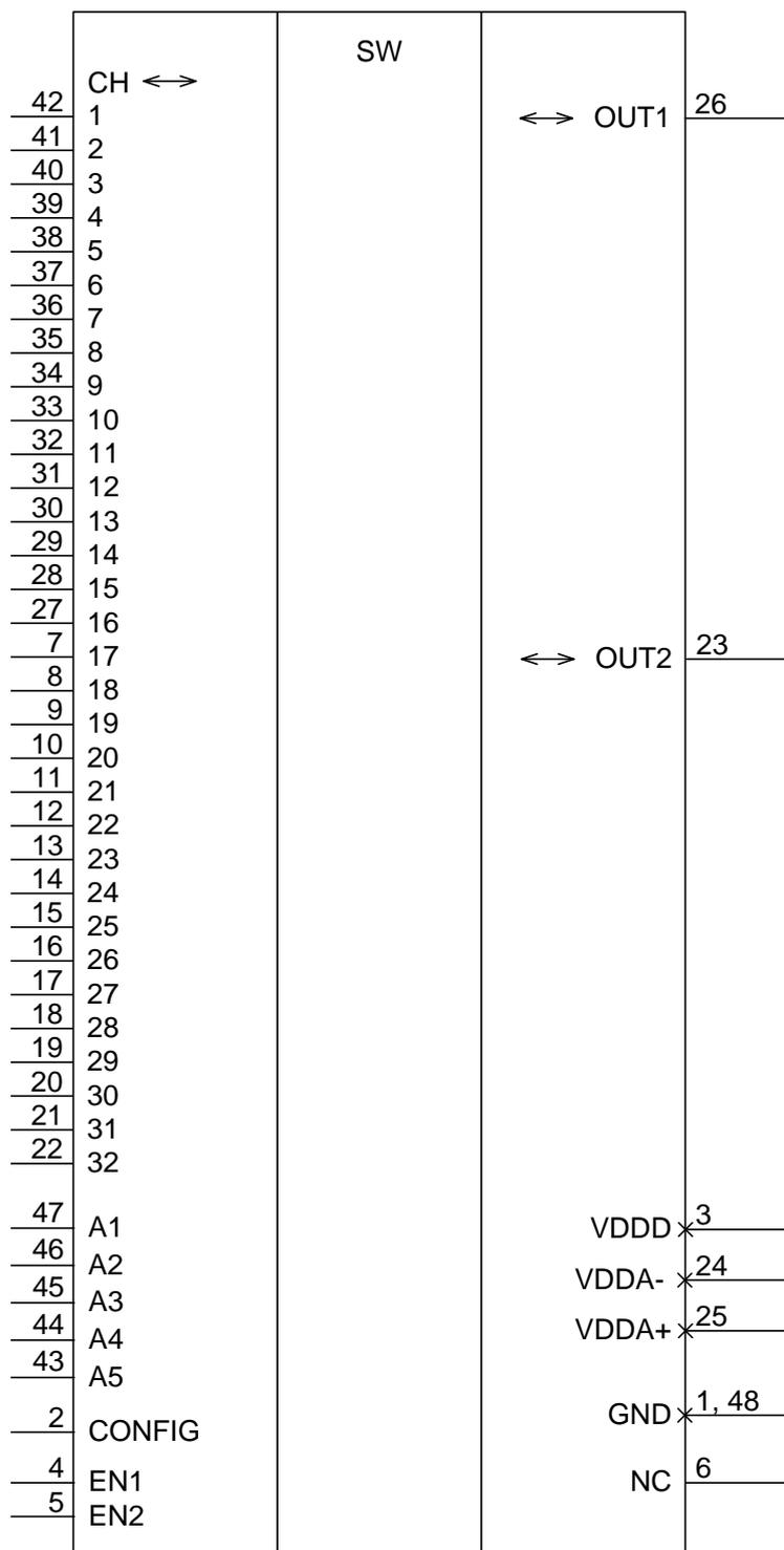
Рисунок 4 – Условное графическое обозначение микросхем 1923КН015
