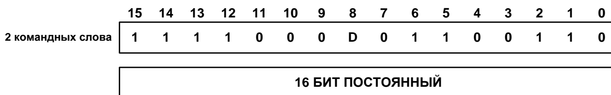
Рисунок 16–30 – Команда RPT с 16-разрядной непосредственной адресацией
