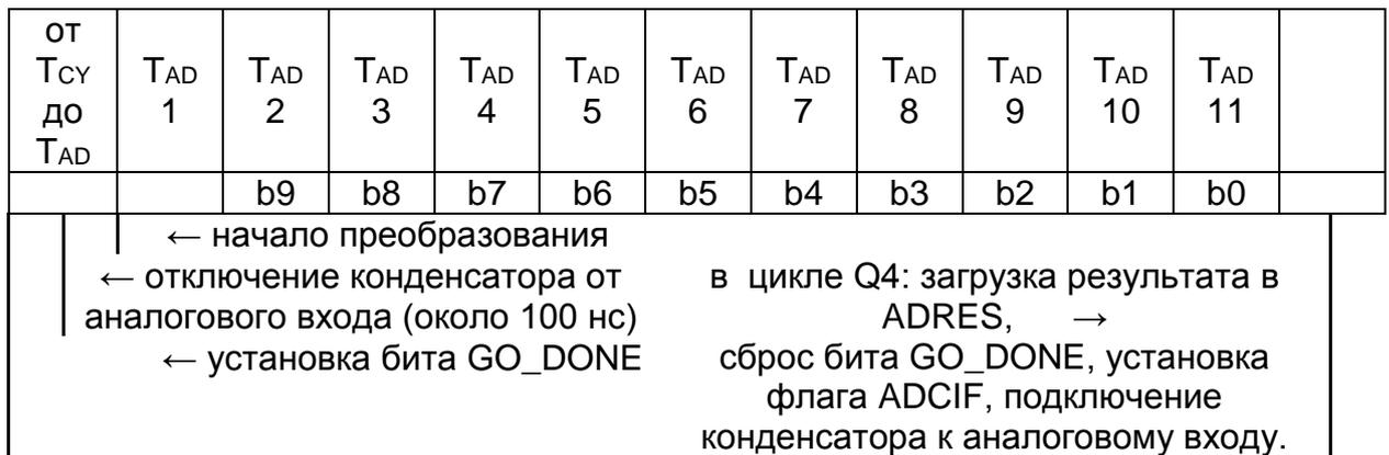
**Рис. 52** Работа модуля АЦП по тактам
