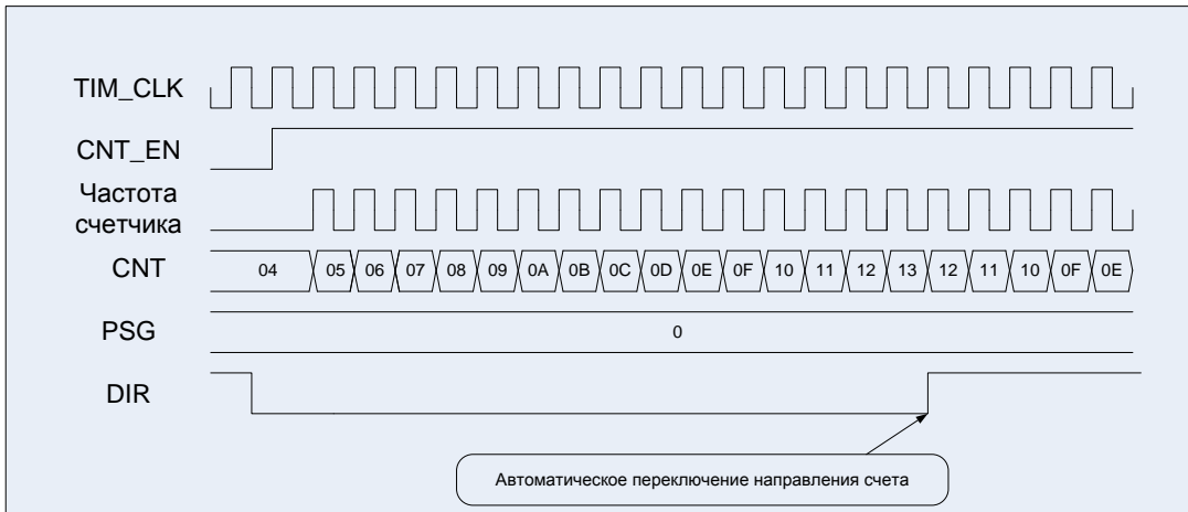
Рисунок 66 – Диаграммы работы таймера, счет вверх/вниз, сначала вверх
