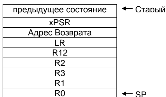
Рисунок 137 – Содержимое стека после того, как исключение прервало обслуживание текущего программного потока
