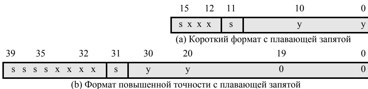
Рисунок 4.10 - Преобразование короткого формата с плавающей запятой в формат с плавающей запятой повышенной точности
