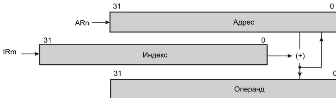
Рисунок 5.13 - Косвенная адресация с предварительным сложением индекса и модификацией
