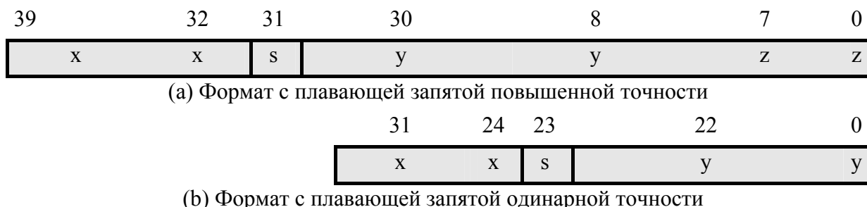
Рисунок 4.12 - Преобразование формата с плавающей запятой повышенной точности в формат с плавающей запятой одинарной точности
