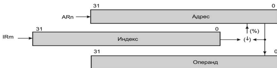
Рисунок 5.18 - Косвенная адресация с последующим вычитанием индекса и циклической модификацией
