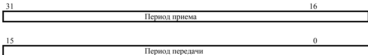
Рисунок 8.2 - Регистр периода таймера приема/передачи
