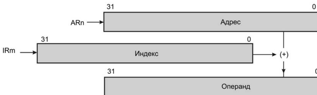
Рисунок 5.11 - Косвенная адресация с предварительным добавлением индекса
