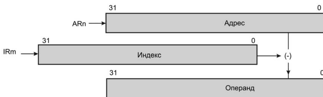
Рисунок 5.12 - Косвенная адресация с предварительным вычитанием индекса
