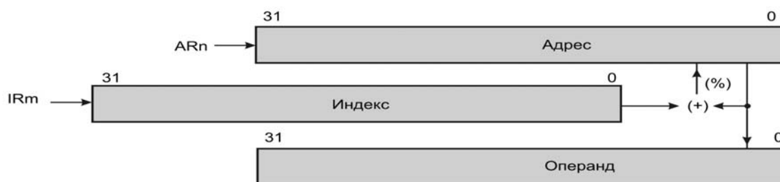
Рисунок 5.17 - Косвенная адресация с последующим сложением с индексом и циклической модификацией
