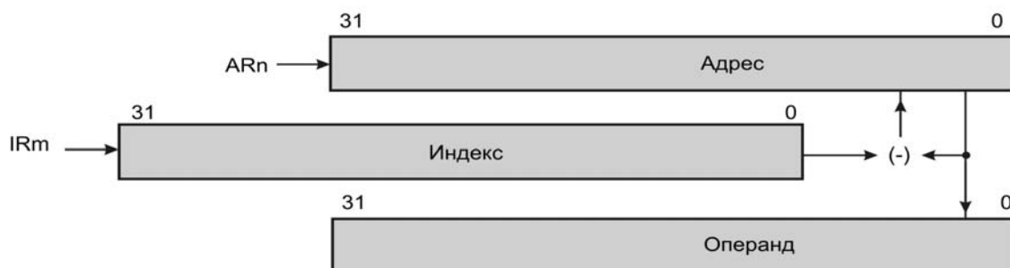
Рисунок 5.16 - Косвенная адресация с последующим вычитанием индекса и модификацией
