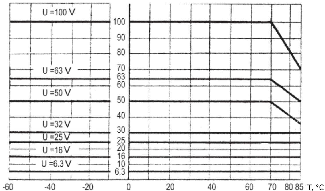
**Значения электрических параметров конденсаторов при поставке**
