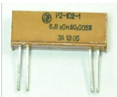
Прецизионные токочувствительные фольговые резисторы с малым значением температурного коэффициента сопротивления P2-102, предназначены для применения в качестве эталонной опоры для получения особо точных сигналов, как по напряжению, так и по току, для внутреннего монтажа.
