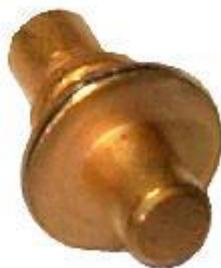
Сверхвысокочастотные диоды переключательные, кремниевые эпитаксиальные с р-і-п структурой в металлокерамическом корпусе типа КД-105, предназначенные для работы в коммутационных устройствах сантиметрового и дециметрового диапазонов волн.
