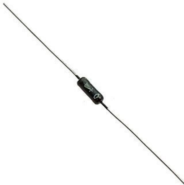
Кремниевые эпитаксиально-планарные коммутационные р-і-п диоды в металло-стеклянном корпусе, предназначенные для коммутации высокочастотных сигналов в диапазоне частот от 30 до 300 МГц.
