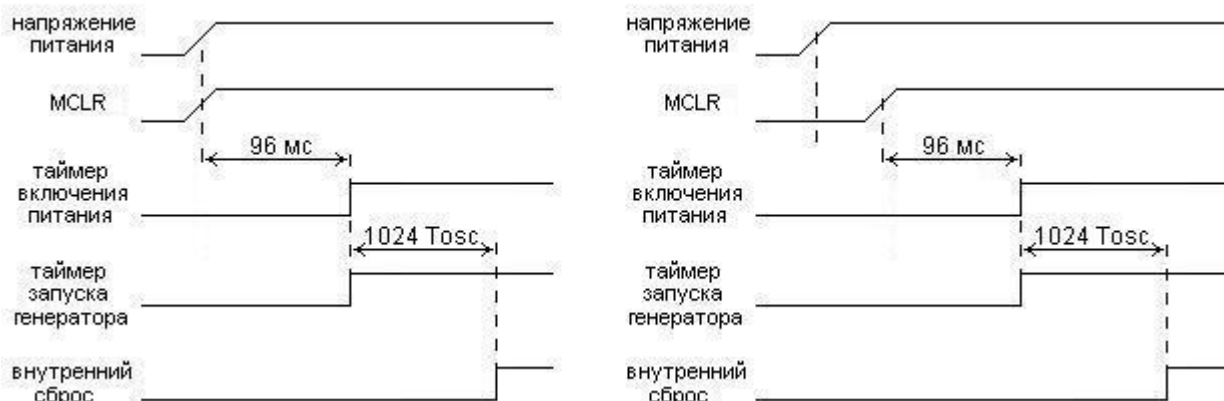
Рис. 12 Последовательность удержания в режиме сброса по включению питания. MCLR подсоединен к напряжению питания (слева). MCLR не подключен к напряжению питания (справа)
