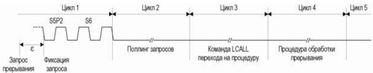
Рисунок 4.7 – Запрос и обработка прерывания
