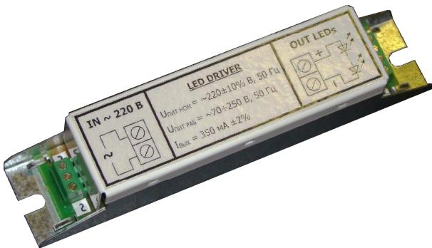
Устройства предназначены для электропитания от сети переменного тока источников света на базе кластеров, составленных из последовательно соединенных сверхярких светодиодов в количестве от 3 до 10 шт постоянным током 350 мА.
