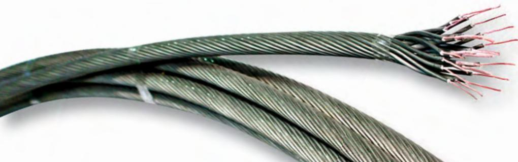
Кабель нагревостойкий многожильный с минеральной изоляцией со стальной оболочкой поверх каждой изолированной жилы для системы управления АС. Кабель предназначен для эксплуатации в следующих условиях: в воздушной среде при температуре от минус 60 до плюс 270 °С; при относительной влажности до 98% при температуре до 40 °С.
