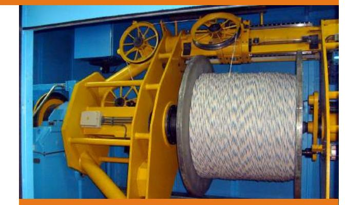
■ Бугельная крутильная машина EN-RL 1600/1+5 фирмы «Caballe» предназначена для скрутки изолированных жил (до 5 жил) силовых кабелей сечением 16,0-150,0  $\text{мм}^2$ .
