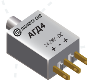
Адаптер АГ Для двухцветных трехвыводных СИД с общим катодом Выходы 2.8x0.8 мм под клемму
